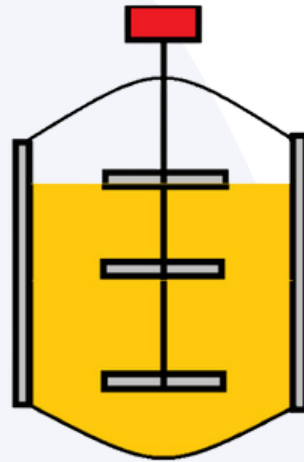
Figura B: Adición del aceite base restante una vez que el mejorador sólido del índice de viscosidad se ha solubilizado.
