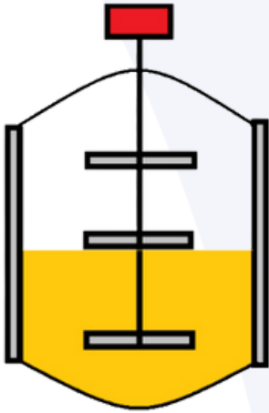
Figura A: Adición del aceite base y del mejorador sólido del índice de viscosidad hasta el impulsor.
